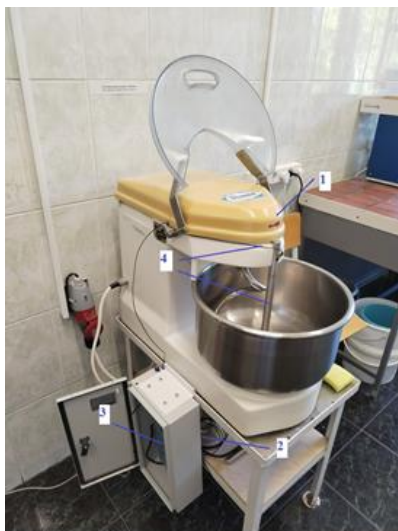
Рисунок 1 – Информационно-измерительная система для определения реологического поведения ржаного теста в процессе замеса
