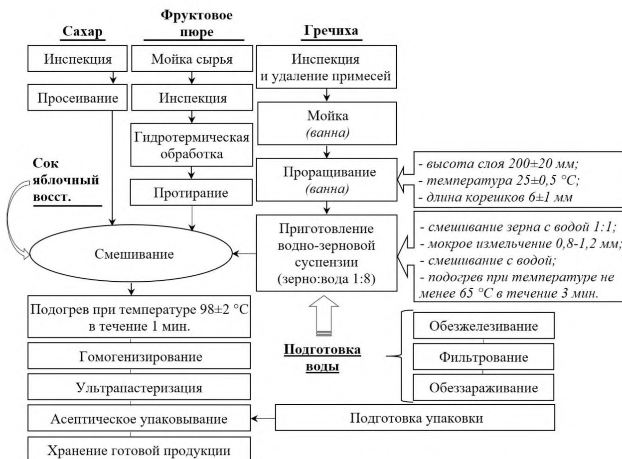
Рисунок 13 – Технологический процесс производства безалкогольных напитков из пророщенной гречихи с фруктовым компонентом
