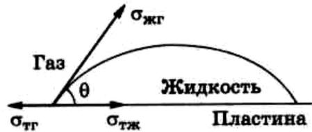
Рисунок 3.18 – Капля жидкости на твердой смачиваемой поверхности
