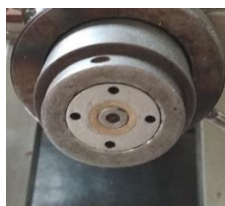
Рис. 2. Отверстия матрицы экструдера диаметром 3 миллиметра
