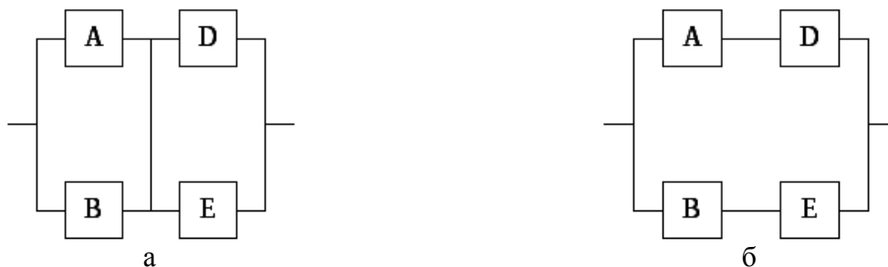
Рисунок 3 – Преобразования мостиковой схемы при абсолютно надежном (а) и отказавшем (б) элементе C
